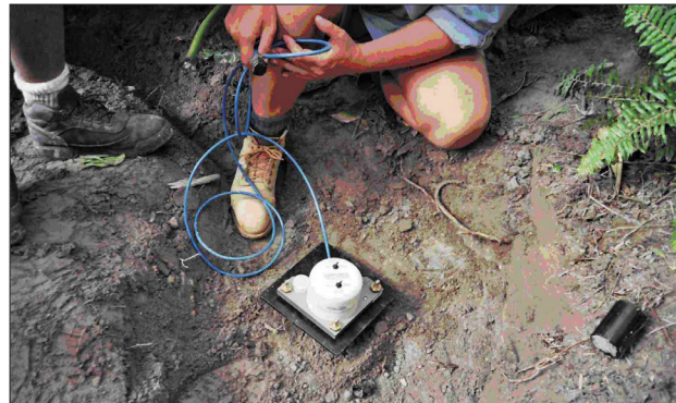
Abb.2: Ein Neigungsmesser ist auf der Vulkaninsel Montserrat in Gebrauch. (Foto: Peter Kennett)
