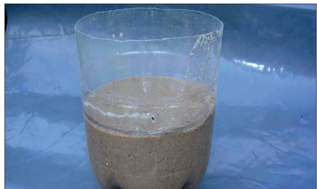
Abb. 3: In einem Behälter mit losem Sand wird die Porosität gemessen. (alle Fotos: Peter Kennett)
