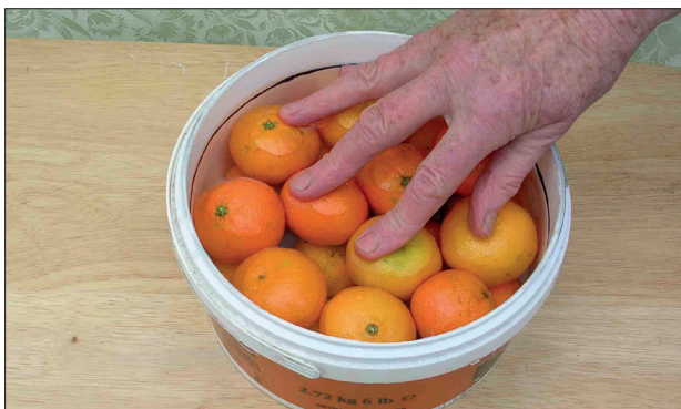
Abb. 1: In einem Behälter mit Orangen wird die Porosität gemessen.
