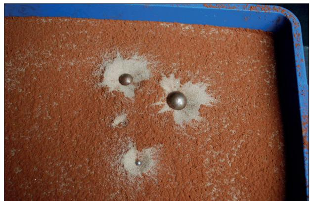
Abb.3: Krater in einer mit Sand gefüllten Box (mit einer Schicht aus Kakao). Sie sind durch das Fallenlassen von vier Stahlkugeln entstanden. (Foto: Peter Kennett)
