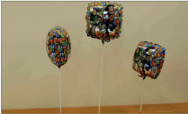
Abb.1: Modell-„Gebäude“ unterschiedlicher Höhe, bei denen mit Helium gefüllte Ballons benutzt wurden (Foto: Peter Kennett)
