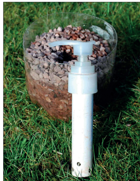
Abb.2: Die Abbildung zeigt ein Stück perforiertes Rohr, das um das Pumpenrohr gelegt wurde um Verstopfungen zu verhindern. (siehe "Materialliste")
