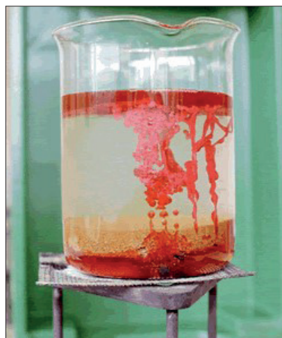
4: und 5. mehr „Wachsrohre“ entwickeln sich und „Intrusionen“ bilden sich als Wachsets im kalten Wasser
