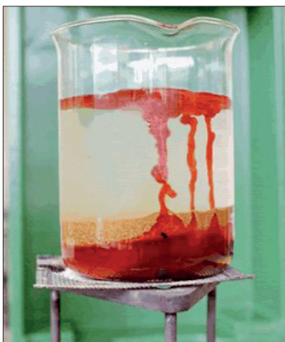
4: und 5. mehr „Wachsrohre“ entwickeln sich und „Intrusionen“ bilden sich als Wachsets im kalten Wasser
