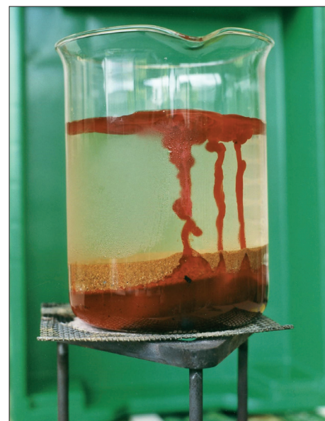
Abb.1: Der Wachs vulkan in Aktion – in diesem Beispiel wird der oberflächliche „Lavaström“ von drei Zuleitungen gespeist, wobei sich „Intrusionen“ in der Nähe ihrer Basen aufbauen - aber alle Ausbrüche sind unterschiedlich. (Photo: Peter Kennett)
