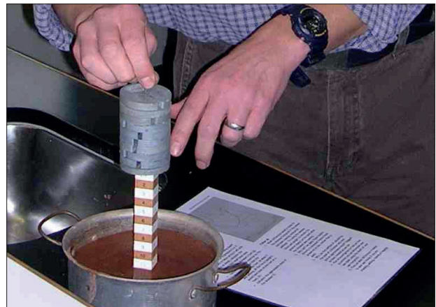
Abb 1: Ein Lehrer zeigt, wie der Druck in dem Behälter voll Sand gemessen wird (Foto: Peter Kennett)
