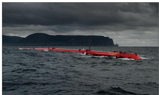
Abb.9: Der Pelamis Wellenkraft-Umwandler wurde im European Marine Energy Test Centre (EMEC) getestet. (Foto: I, P123, the copyright holder of this work, hereby release it into the public domain.)
