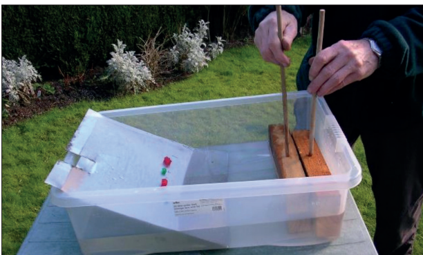
Abb 2: Imitation einer Blattverschiebung, indem die Holzblöcke seitlich aneinander vorbei geschoben werden. (Foto: Peter Kennett)
